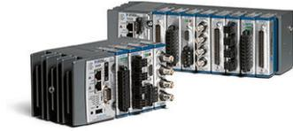
CompactRIO 将开放嵌入式架构与小巧、坚固以及 C 系列模块进行了完美融合，是一种由 NI LabVIEW 驱动的可重配置 I/O (RIO) 架构。每个系统包含一个 FPGA，用于自定义定时、触发以及处理一系列可用的模块化 I/O，可满足任何嵌入式应用程序的需求。
